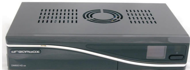
Należy zwracać uwagę, aby nie przysłaniać otworów wentylacyjnych na górnej pokrywie.
