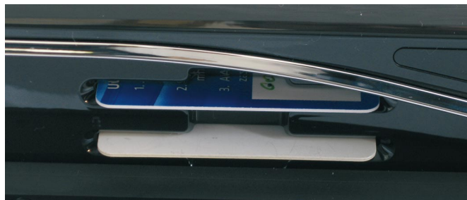
Po odchyleniu klapki wyłaniają się dwa czytniki kart kodowych. Dostęp do dolnej karty jest trochę „ciasny”.
