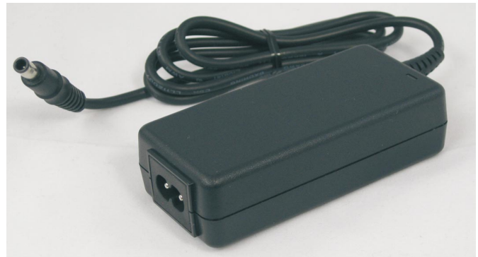
Miniaturowy (9,5 cm x 4,5 cm x 2,5 cm) i lekki (0,17 kg) zewnętrzny zasilacz sieciowy 200-240V 0,6A/12 V, 3,33 A
