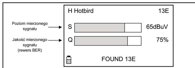
Rys. 3. Wyświetlane informacje na ekranie LCD w trybie „Znalezienia” satelity
